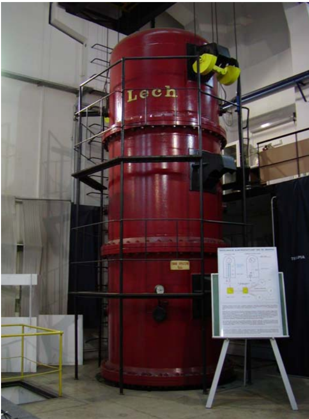
Fig. 6. Warsaw 3 MV Van de Graaf accelerator.
